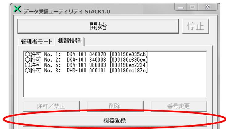
3. DKA-101 が検出できると、機器情報欄に“○許可 No.X DKA-101 XXXXXX ”と表示されます。その欄の接続したい機器を選択し、開始ボタンを押します。これでペアリングは完了です。ペアリングが出来ていれば、PC 画面下のタスクトレイにある緑のアイコンが“I”と表示されます。又 DKA-101 の緑の点滅がゆっくりになります。
